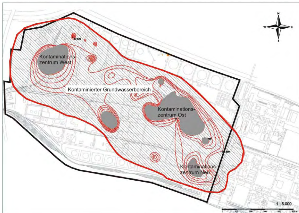
Abbildung 11.8: Ausbreitung von Mineralöl am Grundwasser (Plangrundlage aus Jahresbericht 2001 der OMV AG)
